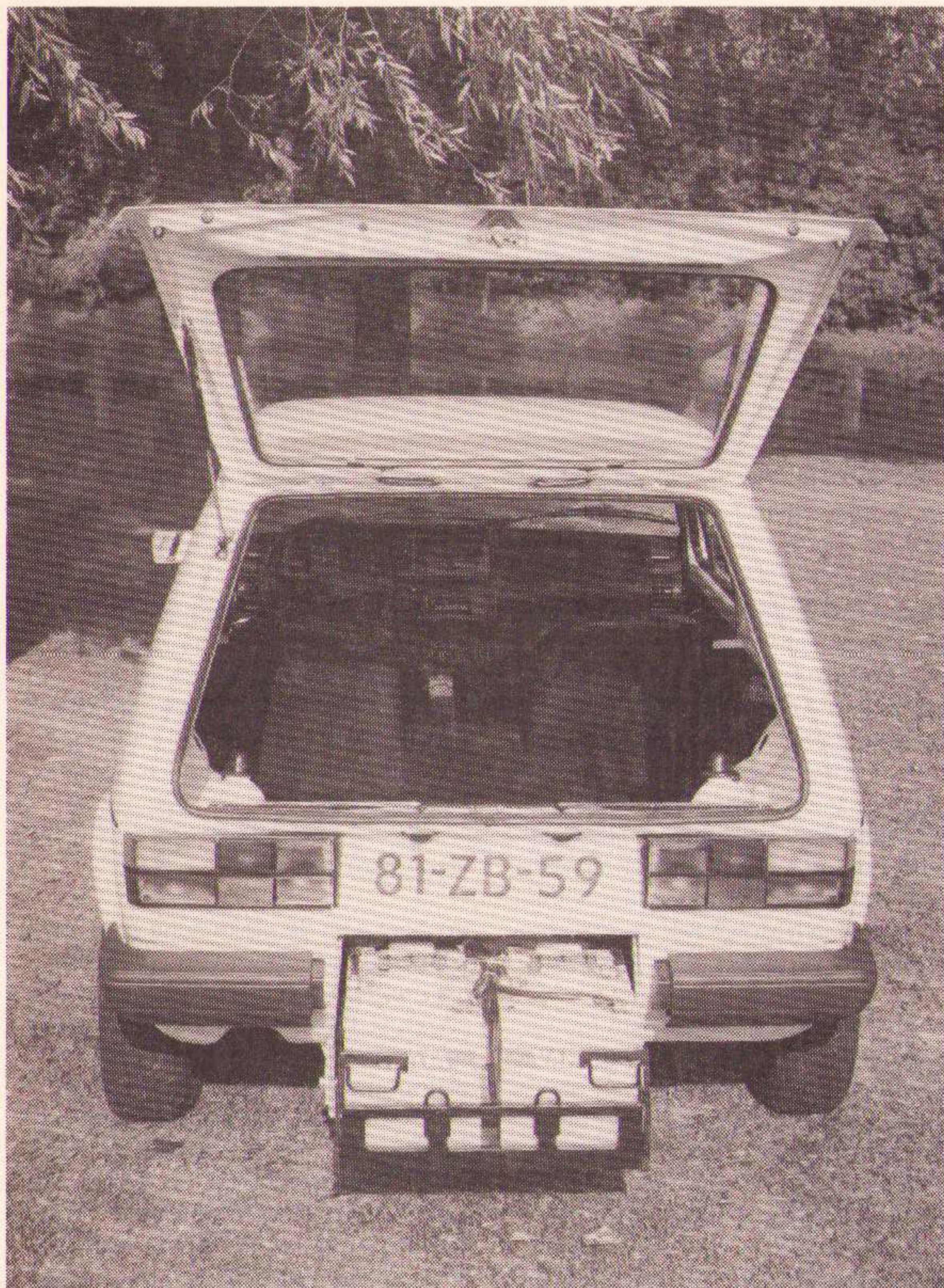
De TH-elektromobiel is opgebouwd rond de centrale accukoker.
